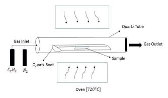
Fig. 1 Chemical Vapour Deposition setup [23]
